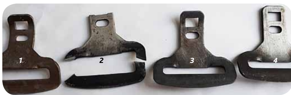
Joonis 5. Karastamise mõju mehaanilistele omadustele. 1 – pehme ja sitke karastamata teras, kergelt painutatav; 2 – karastatud noolutamata detail, mis puruneb kergelt juba väikestel paindekoormustel; 3 – karastatud ja kõrgnoolutatud detaili on võimalik painutada ainult suuremate jõududega; 4 – karastatud ja optimaalsel temperatuuril noolutatud, suure jõuga paindub ainult kergelt
